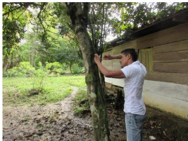
Fotografía 3: Instalación de sensores de humedad relativa y temperatura, en la comunidad Limón Sur, Chisec, A.V.
